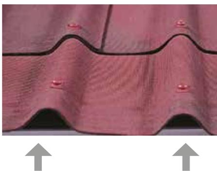
Las ondulaciones de ONDUVILLA® crean un espacio aireado, consiguiendo así una mejor ventilación entre esta y el soporte de cubierta, **evitando humedades** por condensación.
