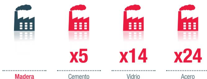
**Comparación de la cantidad de energía necesaria para producir una tonelada de madera, cemento, vidrio y acero.**
